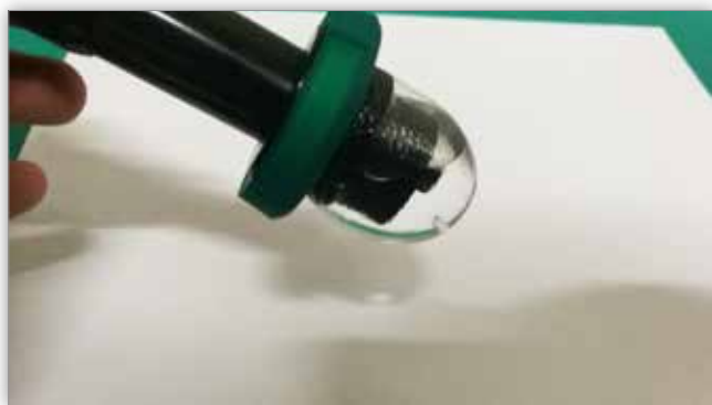
Ryc. 3. Sonda USG 40 MHz z nałożoną nakładką ClearScan®. Fig. 3. 40 MHz ultrasound probe with ClearScan® adapter.
